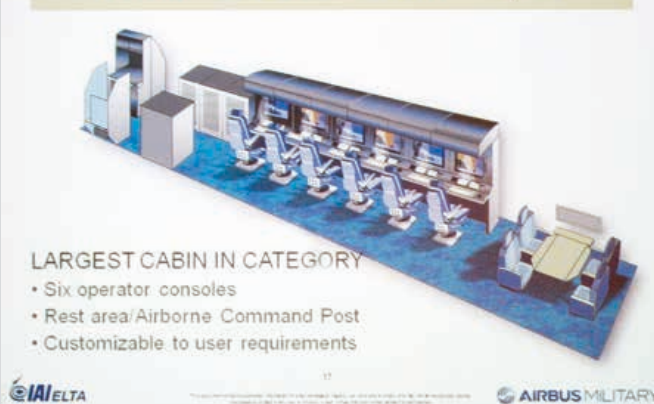
Кадры из презентации программы С-295АЕW, проведенной компаниями «Эрбас Милитари» и ELTA на салоне в Ле-Бурже, поясняющие компоновку антенной системы радиотехнического комплекса и кабины операторов
