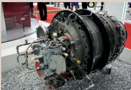
Перспективный двигатель ВК-800В для легких вертолетов пока еще находится в стадии стендовых испытаний и доводки
