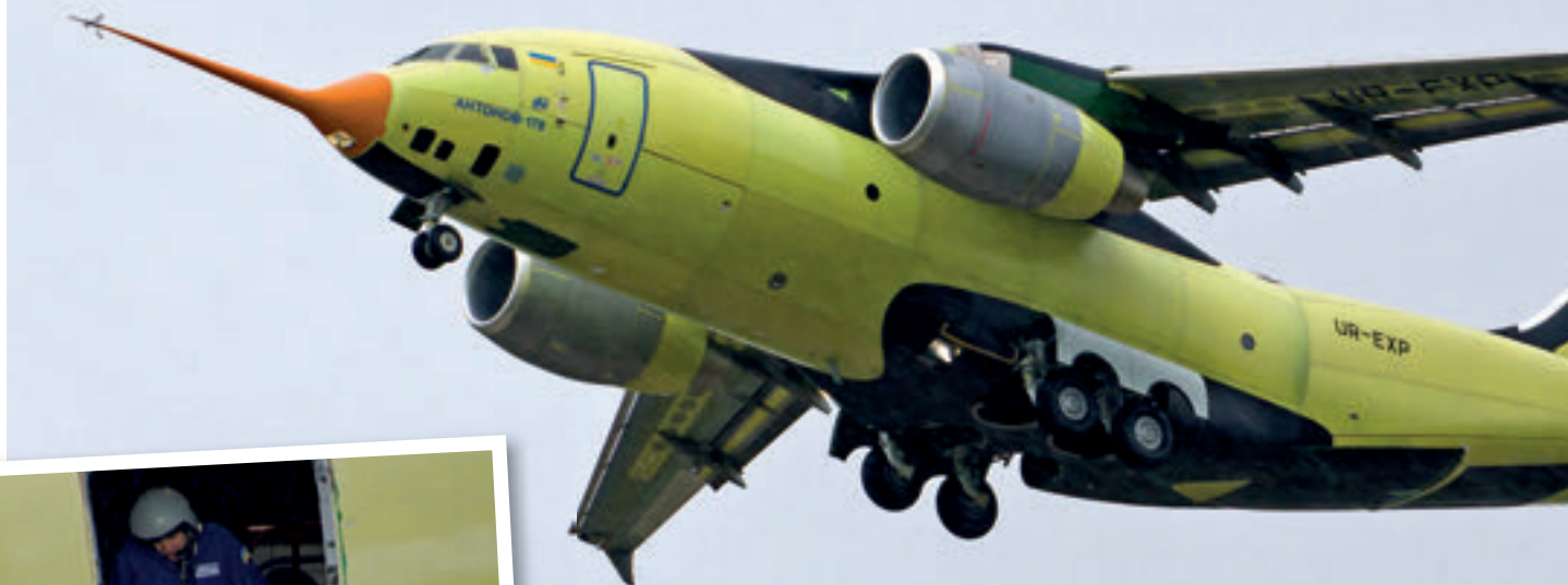
Ан-178 №001 в киевском небе. На время испытаний самолет оборудовали характерной «антоновской» экспериментальной носовой штангой с выносными приемниками воздушного давления и датчиками угла атаки и сноса
