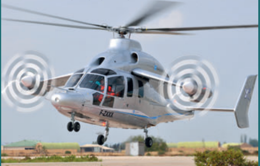
На экспериментальном «гибридном» вертолете Х3 в июне 2013 г. была получена рекордная скорость 472 км/ч
