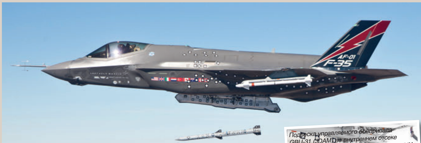
Первое испытание по отделению ракеты AIM-120 от самолета F-35A (AF-1) в полете, 19 октября 2012 г.
