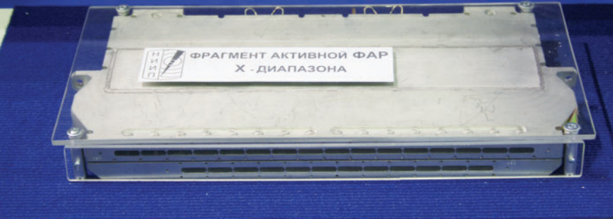
Фрагмент натурального опытного образца АФАР X-диапазона разработки НИИП им. В.В. Тихомирова, впервые показанный публично на авиасалоне МАКС-2007 в августе 2007 г.
