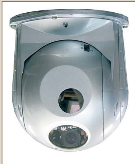
Гражданские версии обзорных оптико-электронных систем – системы оптического наблюдения СОН-612 (слева) и СОН-112 (справа). Первая используется компанией «Пергам-Инжиниринг» для воздушного дистанционного мониторинга линий электропередач, а вторая установлена по заказу австрийской компании «Даймонд Эркафт» на легкомоторный самолет «Твин Стар» для полицейского патрулирования и ведения телерепортажей
