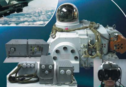
Оптико-электронная прицельная система ОЭПС 30И (изделие 31Е-МК) самолета Су-30 и его модификаций
