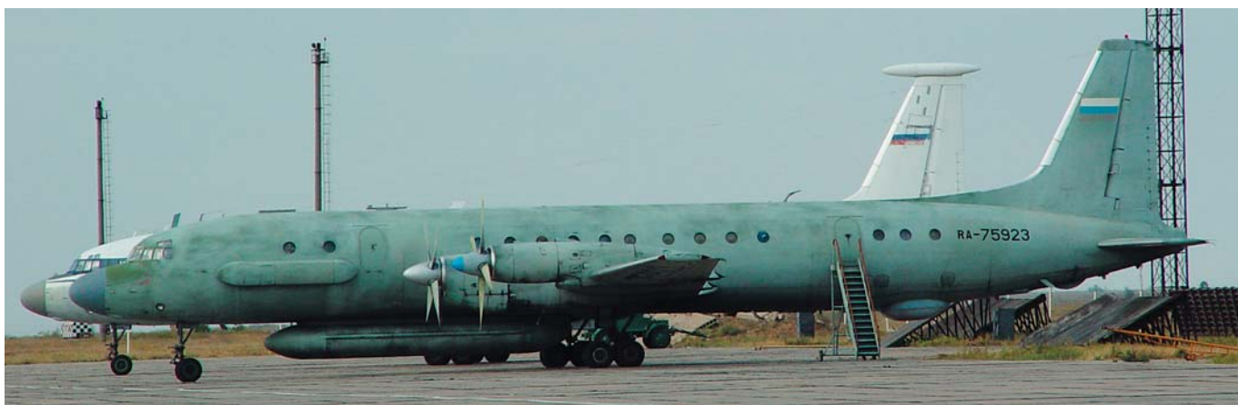
Внизу: самолет радиоэлектронной разведки Ил-20М, за ним – воздушный командный пункт Ил-22. Оба созданы на базе пассажирских Ил-18Д
