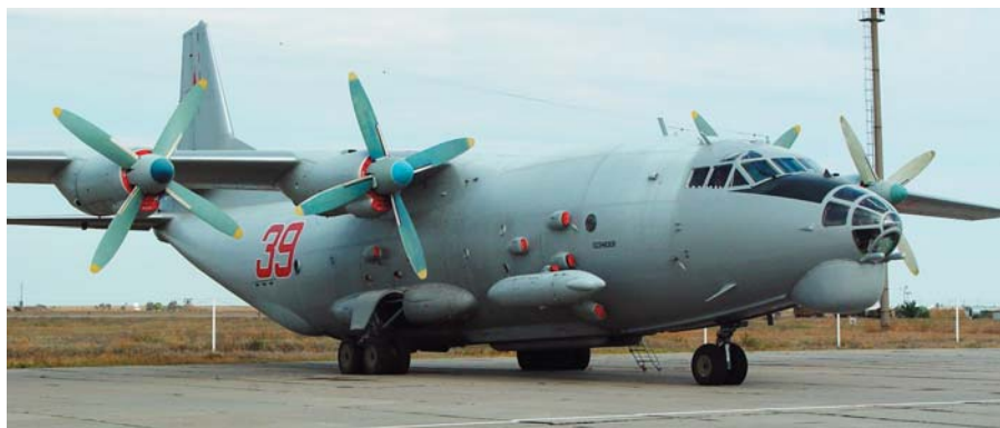
Справа: самолет – постановщик помех Ан-12ППС, созданный на базе транспортного Ан-12. Несколько таких машин уже много лет базируются в Ахтубинске
