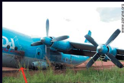
Транспортный самолет Ан-12Б конголезской авиакомпании Wimbi Dira Airways (регистрационный номер 9Q-CWC), в результате аварийной посадки которого на аэродром Ару (ДРК) 4 октября погибло два человека и еще несколько получили тяжелые ранения
