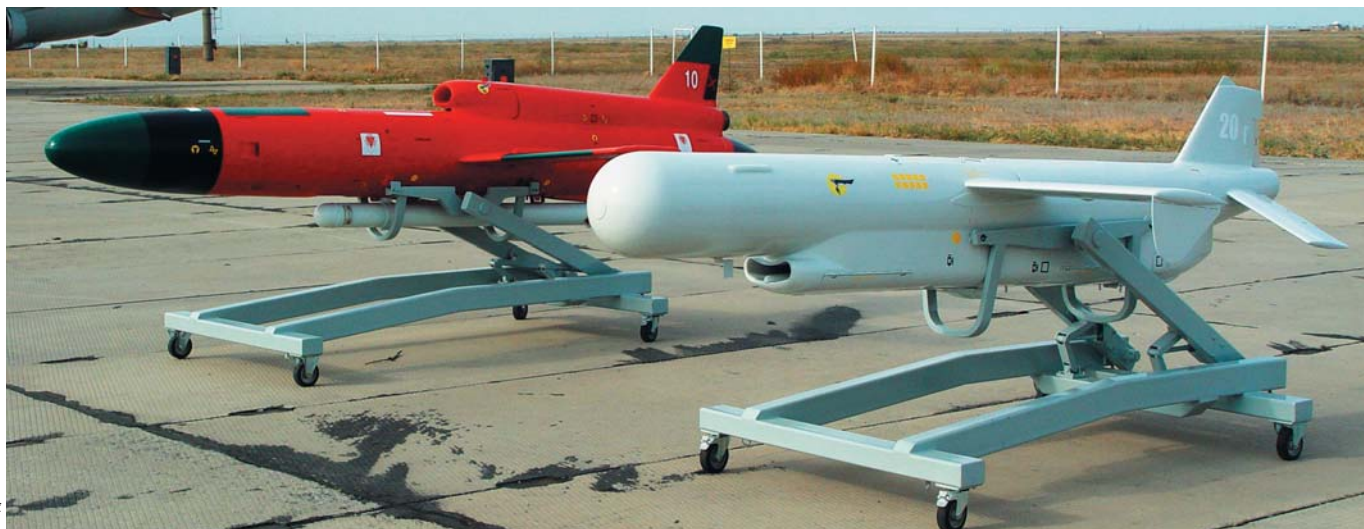
Беспилотные реактивные самолеты-мишени ОКБ «Сокол»: слева – широко известная по авиасалонам последних лет мишень «Дань», справа – более ранняя, но до сих пор ни разу не показывавшаяся публично мишень «Крыло». Она прошла госиспытания в ГЛИЦ в 1978 г. и была принята в вооружение еще в советские времена
