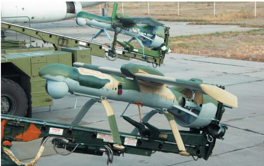
Пара тактических беспилотных самолетов-разведчиков «ОКБ им. А.С. Яковлева» типа «Пчела» на двух разных пусковых установках – на автомобильной и гусеничной базе
