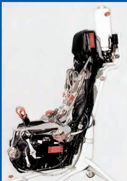
Кресла для современных вертолетов, слева направо: катапультно-амортизационная система (КАС) К-37-800М, применяемая на вертолетах Ка-52; амортизационное кресло «Памир» для вертолетов Ми-28Н; амортизационное кресло АК-2000 для вертолетов Ка-226, Ка-62 и др.
