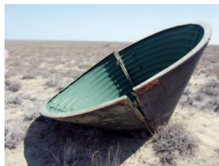
Вверху: найденный на месте падения «Днепра» головной обтекатель ракеты Внизу: все, что осталось от вышедших «Днепром» спутников, среди которых была и белорусская «БелКА»
