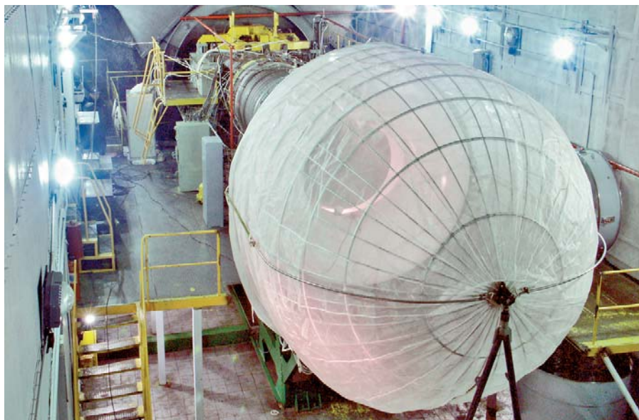
Испытания «Бурлака» на стенде НПО «Сатурн» в Рыбинске. Слева – пост управления испытываемым двигателем, справа – Д-30КП-3 на стенде
