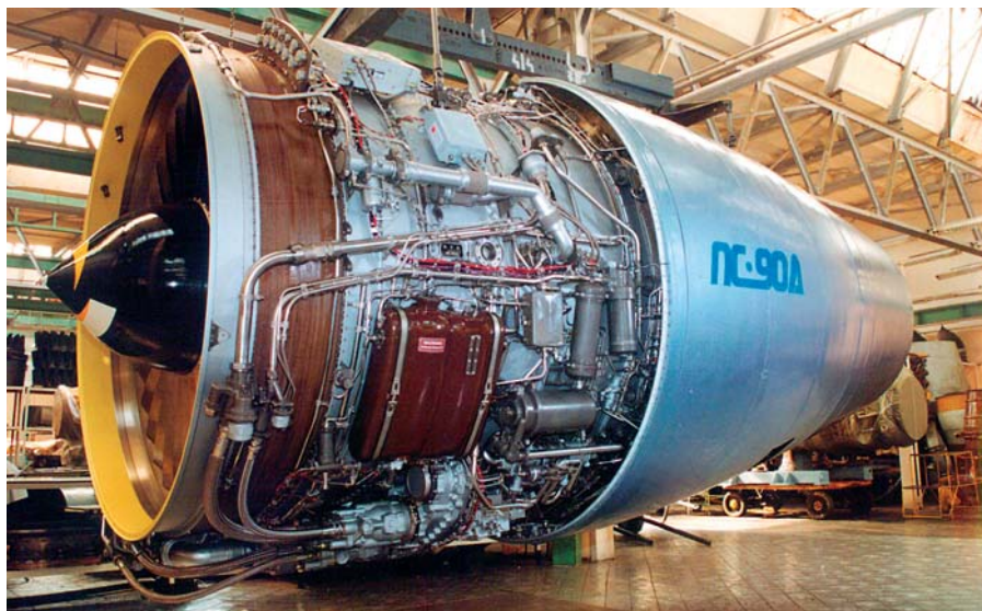
Турбовентиляторный двигатель ПС-90А для самолетов Ил-96-300 и Ту-204. На его базе в Перми создан двигатель ПС-90А-76 для самолетов типа Ил-76
