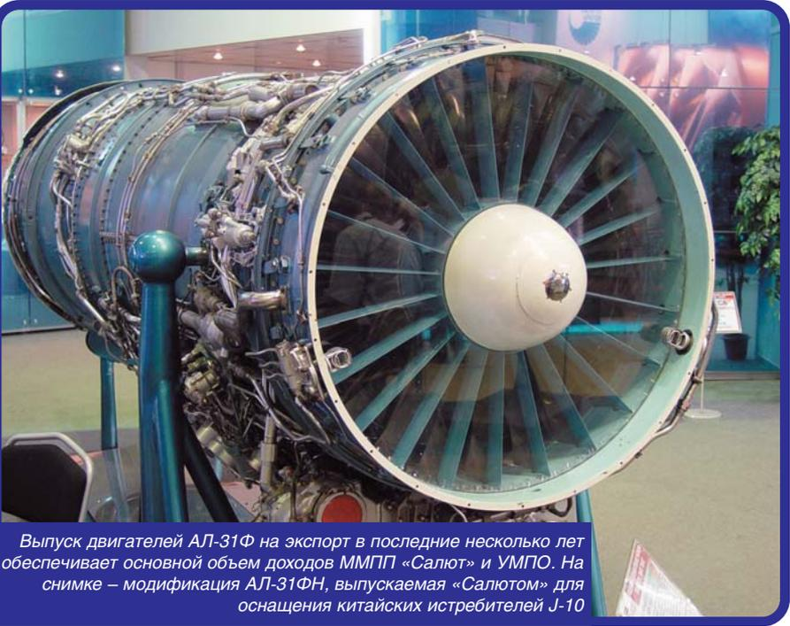
Выпуск двигателей АЛ-31Ф на экспорт в последние несколько лет обеспечивает основной объем доходов ММПП «Салют» и УМПО. На снимке – модификация АЛ-31ФН, выпускаемая «Салютом» для оснащения китайских истребителей J-10
