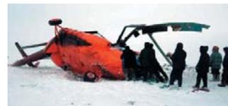
По предварительным данным, на завершающем этапе полета, примерно в 300 м от площадки планируемого приземления, вертолет в результате интенсивного маневра с углом тангажа на пикирование и левым креном, практически без поступательной скорости столкнулся с землей.
