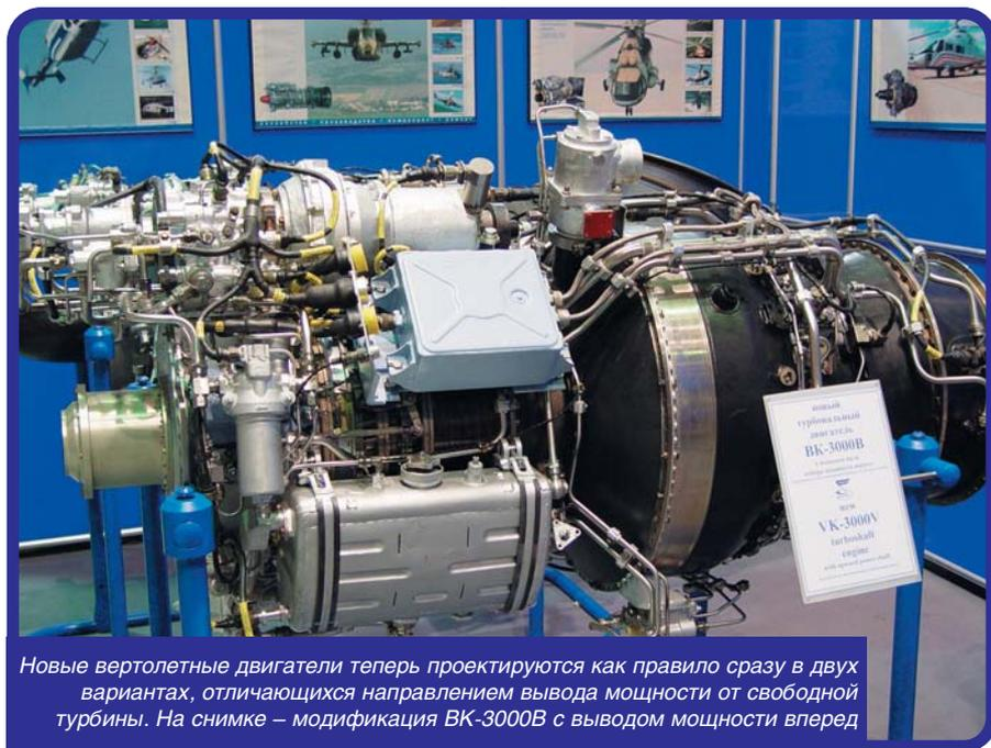
Новые вертолетные двигатели теперь проектируются как правило сразу в двух вариантах, отличающихся направлением вывода мощности от свободной турбины. На снимке – модификация VK-3000V с выводом мощности вперед
